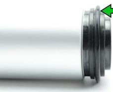
Durch die richtige Montage des O-Rings wird die Öffnung nicht verschlossen und die Kraftstoffpumpe kann Kraftstoff ansaugen.
